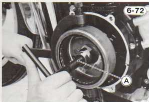
A. Rotor Puller: 57001-254
