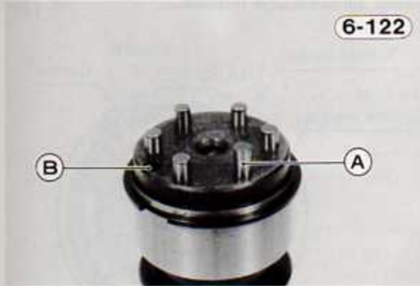
A. Long Shift Drum Pin B. Hole
