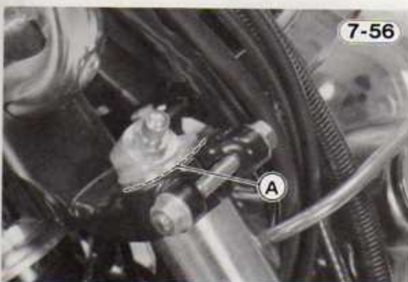
A. Inner Tube Upper End
